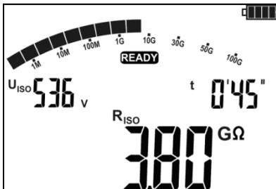
Nach Abschluss oder Abbruch der Messung, werden die Ergebnisse angezeigt. Es werden alle erzielten Messergebnisse angezeigt (sogar, wenn die Messung unterbrochen wurde).
