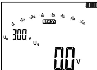
Das Prüfgerät ist zur Messung bereit.
