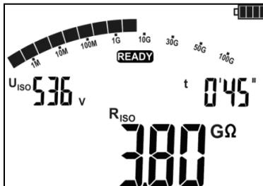
Nach Abschluss oder Abbruch der Messung, werden die Ergebnisse angezeigt. Es werden alle erzielten Messergebnisse angezeigt (sogar, wenn die Messung nach 60 Sek. unterbrochen oder abgebrochen wurde.
