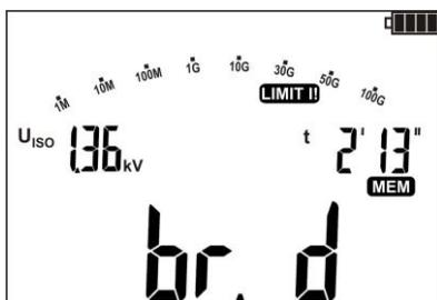
Wird die Spannungsfestigkeit der geprüften Isolierung überschritten und kommt es zu einem Durchschlag, erscheint im Hauptanzeigefeld die Meldung br. d - Breakdown.
